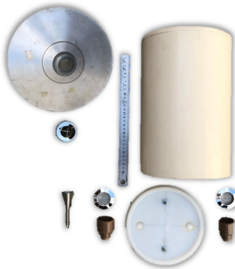
Figura 14: Principais componentes da parte externa do pluviômetro.
