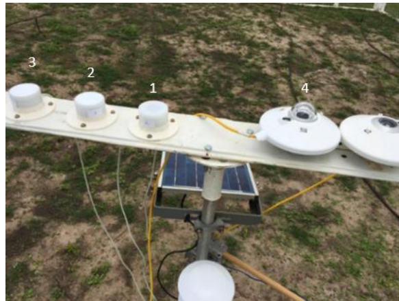
Figura 5. Protótipos de piranômetros com os difusores em teste e o piranômetro de referência, KIPP&ZONEN CMP22. (Autoria própria)
