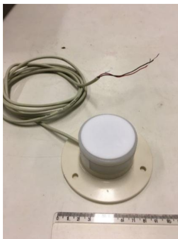
Figura 3. Corpo do piranômetro proposto com difusor de acrílico. (Autoria própria)
